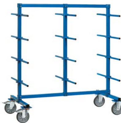
24 Tragarme zweiseitig (12 Stück je Seite) Nutzlänge 370 mm, Ständer-Nutzhöhe 1450 mm. Tragkraft pro Etage 120 kg (60 kg/Seite).
